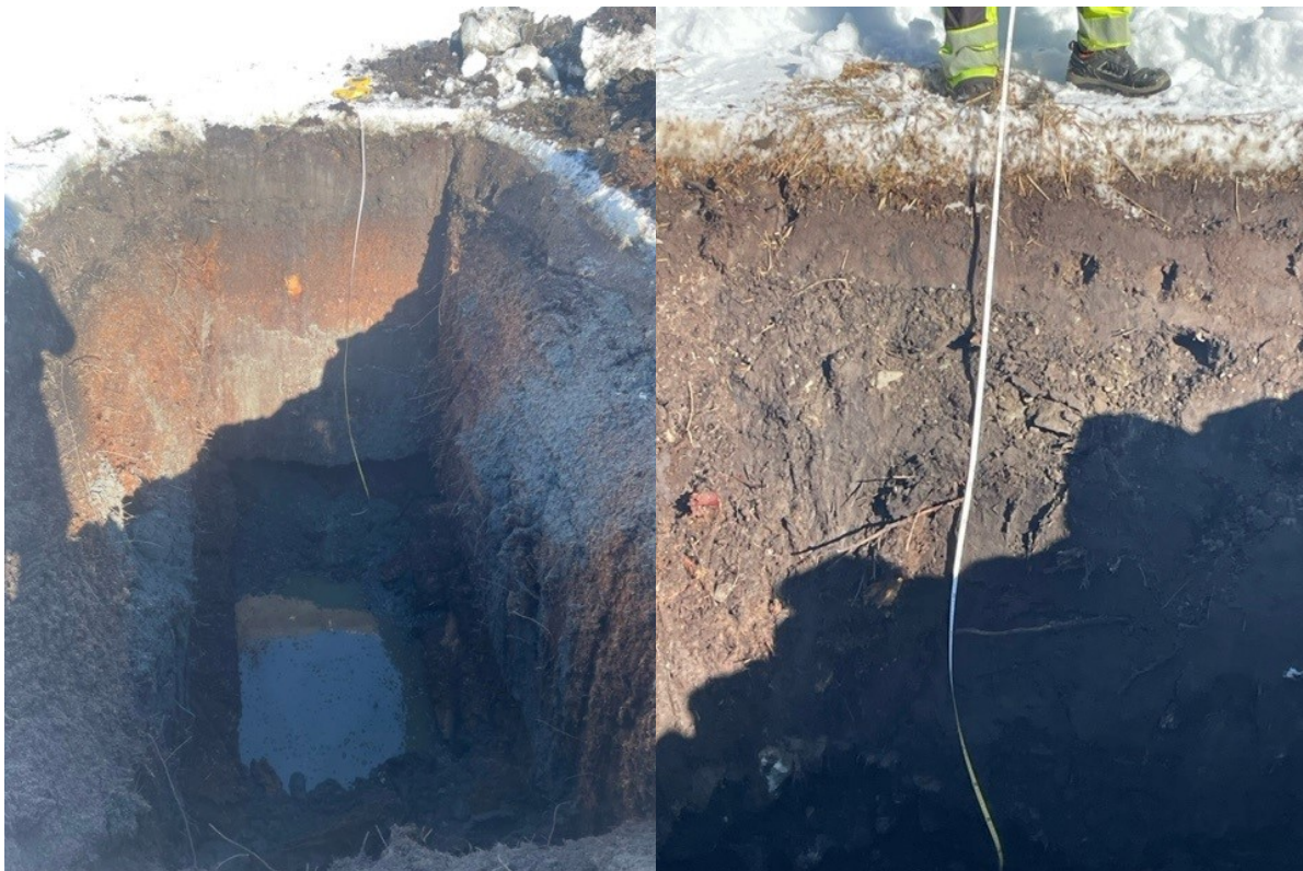
Tverrsnitt av prøvegraving viser at matjordlaget er ca 30 cm dypt, og at løsmasser består av silt og myr.
